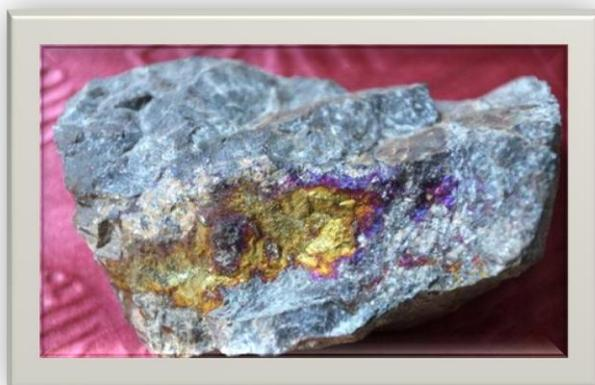
该铜矿床产于一套变质的火山杂岩中，矿体主要赋存于强蚀变带内，矿体裂隙不发育，硬度大，稳固性好，矿物成分简单，金属矿物主要有黄铜矿、黄铁矿、磁黄铁矿，次为闪锌矿等。脉石矿物主要有阳起石，透辉石，方解石等，矿石结构主要为他形粒状结构，半自形—形晶状结构等，矿石构造以浸染状为主，其次有细脉状，团块状等。
